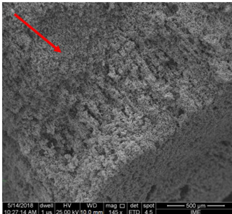
**Figura 3** Micrografia da estrutura porosa com 145x de ampliação. A seta vermelha mostra a direção de congelamento.
