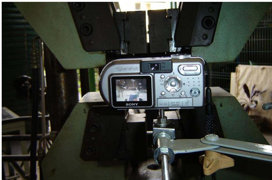
Figura 3. Suporte para a câmera na máquina de tração.
