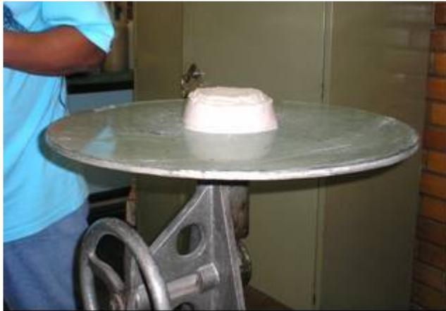
**Figura 4** – Mesa de Ensaio de consistência com argamassa após a retirada do molde cônico.
