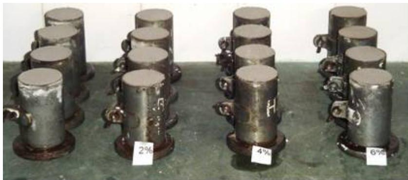
**Figura 3-** Moldes preenchidos com argamassa, da coluna da esquerda para direita porcentagem de resíduo de 0%, 2%, 4% e 6% respectivamente.
