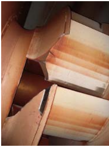
Figura 1. (a) quebra de um pedaço da chapa do cone externo do rotor; (b) ponto de operação mensurado.
