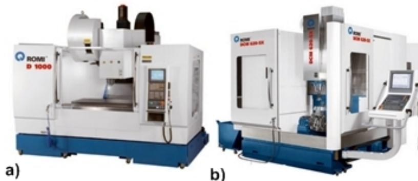
**Figura 2:** Ilustração dos Centros de Usinagem: (a) 3 Eixos; (b) 5 Eixos.
