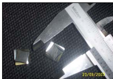
Figura 2. Detalhe das pastilhas após retífica e afiação (prontas para o uso) (4) .
