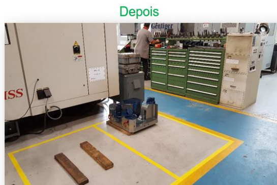
Operador realiza a troca de peças ao lado do seu posto de trabalho durante o setup
