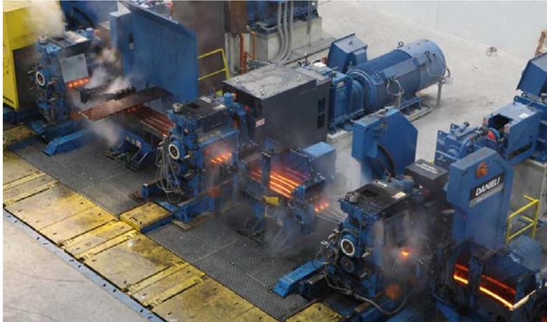
Figura 1. Laminación dividida: formación de cuatro hilos a partir de una palanquilla (*slitting*) [2].
