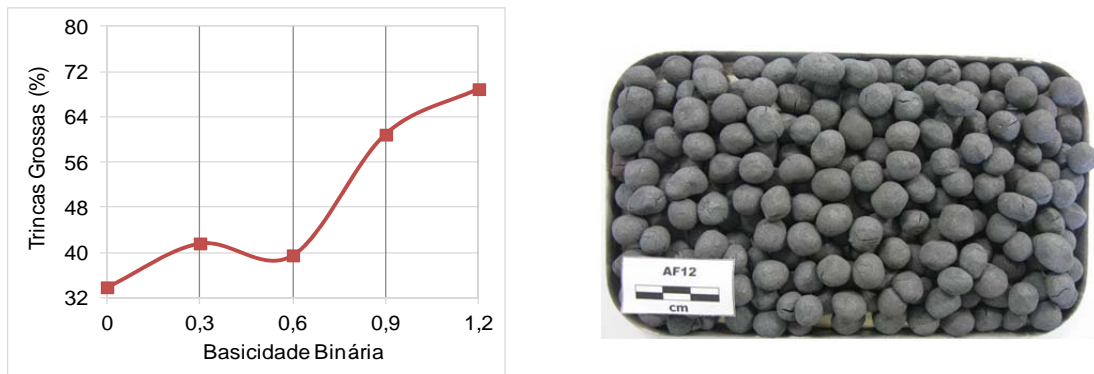
Figura 2. Presença de “trinca grossa” em função da basicidade binária das pelotas queimadas .
