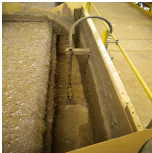
Figura 6. Chuveiro quebra espuma na calha de transbordo da célula de flotação.
