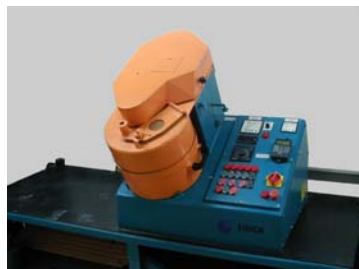
Figura 1. Misturadores do Centro de Testes Eirich. 10 litros para testes de bancada.
