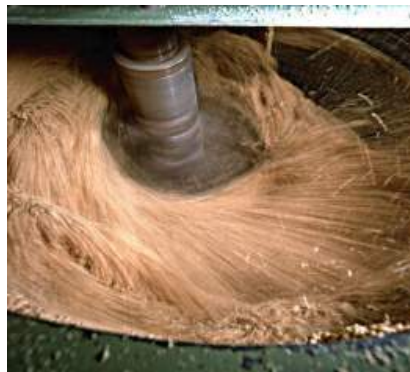
Figura 19. Fluxo de movimentação do material no interior do misturador.
