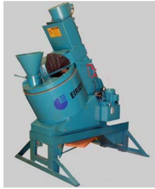
Figura 2. Misturadores do Centro de Testes Eirich. 75 litros para testes semi industrial.
