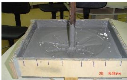
Figura 4 - Montagem da caixa e enchimento com resina termofixa
