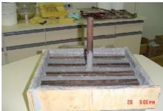
Figura 5 – Colocação de barras SAE 1020 para reforço
