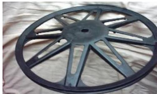
Figura 11 – Peça protótipo em PA 6:6 30% FV
