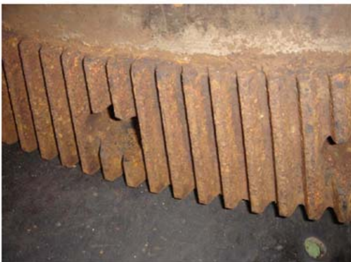
Fig. nº 11: Corrosão causou perda dimensional dos dentes.
