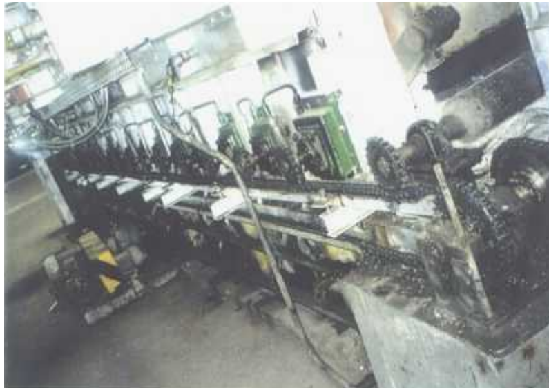
Figura 2. Vista geral mostrando uma única corrente acionando os 16 rolos.
