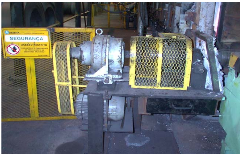
Figura 4. Sistema de acionamento posicionado na extremidade do forno
