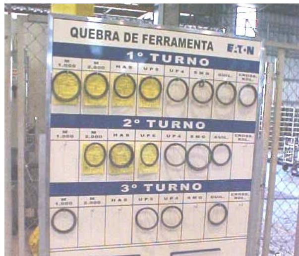
Figura 10: Sistema de controle “visual” de falha de ferramentas de forjamento: Etiqueta de controle de falha (à esquerda) e quadro de falha por célula de produção.
