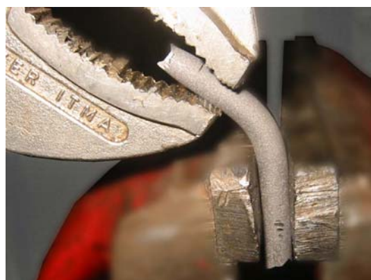
Figura 3. Flexão manual até a fratura da haste íntegra após o ensaio de tração. Essa haste foi flexionada em três regiões distintas: em local da marcação do número do lote, local de marcas da garra do ensaio de tração e em local isento de defeitos superficiais.
