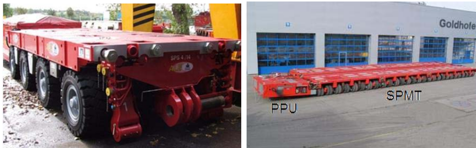
Figura 6. Transportadores de módulos (SPMT) e a unidade motora (PPU). (9)
