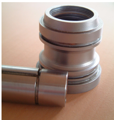
Figura 2 – Molde / Macho de injeção de tampa de garrafa (1)
