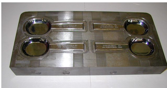
Figura 3 – Molde para colheres dosadoras
