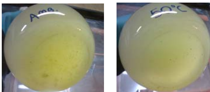
Figura 10 – Presença de grumos na solução gelatinizada em temperatura ambiente e a 50°C.
