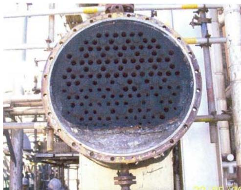
**Figura 2.** Depósito de produto de corrosão no feixe do Permutador de Calor
