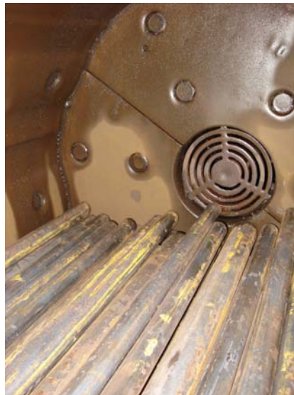
Figura 6: Variáveis definidas para o cálculo do volume de moagem e o detalhe o moinho piloto do CTF carregado com barras, mostrando o orifício de descarga.
