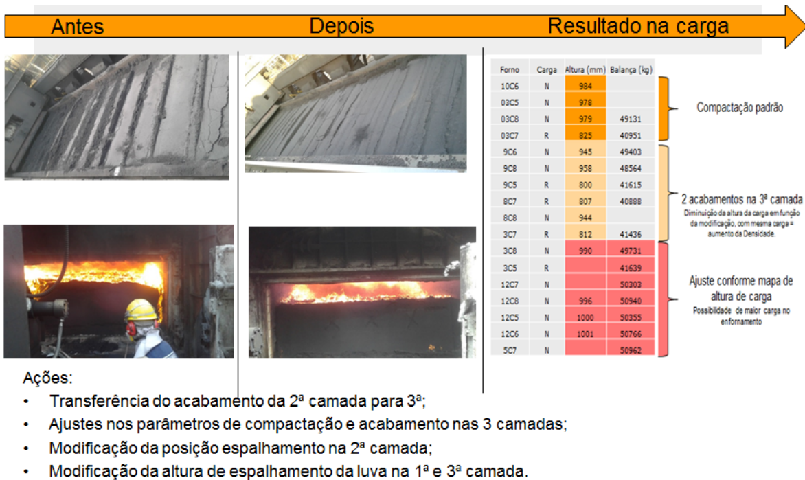
Figura 12 – Melhora no sistema de compactação
