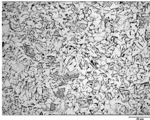
Figura 2. Microestrutura típica de ferrita acicular de um metal de base produzido a partir de processamento termomecânico controlado e resfriamento rápido.
