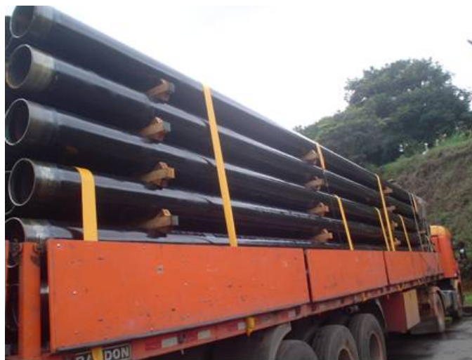
Figura 8 – Cintas de poliéster utilizadas para amarração das cargas
