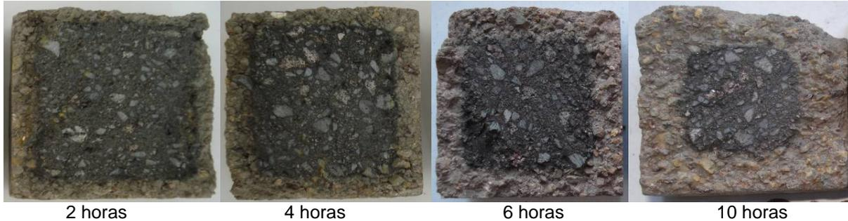
**Figura 1.** Aspecto de las probetas del ladrillo A luego de diferentes tiempos de permanencia – atmósfera de aire.
