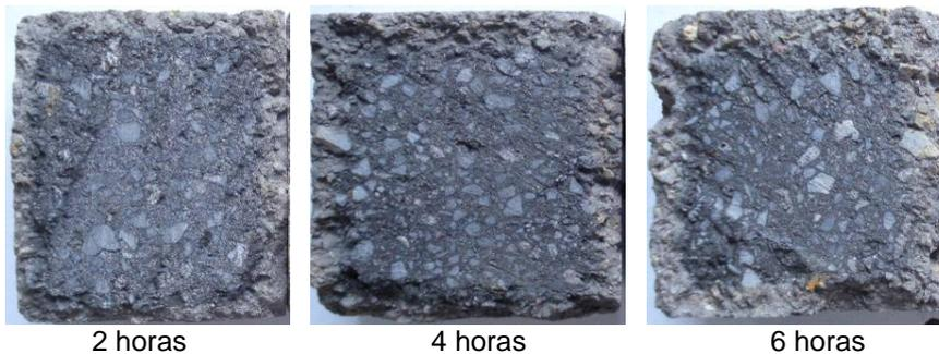
**Figura 3.** Aspecto de las probetas del ladrillo A luego de diferentes tiempos de permanencia – atmósfera con 7%O<sub>2</sub>.
