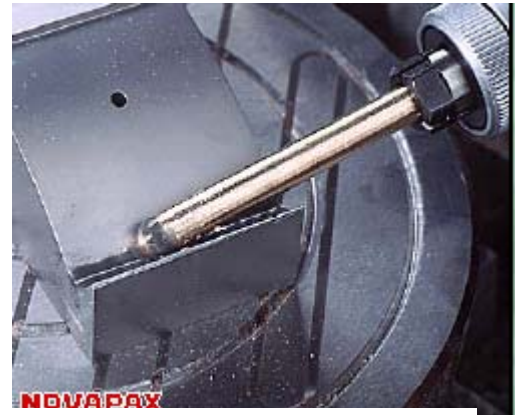
Figura 10. Desbaste com haste de latão e pasta diamantada.
