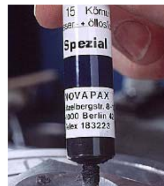
Figura 2. Aplicação da pasta diamantada.
