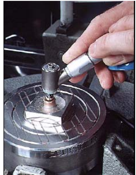
Figura 6. Desbaste da erosão com anel diamantado.
