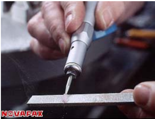
Figura 11. Balanceamento de ponta montada de pedra abrasiva.
