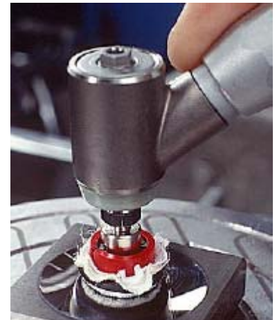
Figura 7. Espelhamento com Feltro e Pasta Diamantada.
