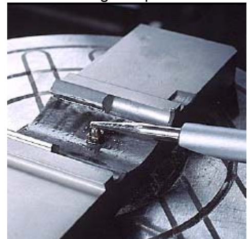
Figura 9. Desbaste com Elemento plástico e pasta diamantada.
