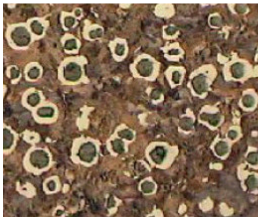
Figura 5. Microestrutura típica do FUCO® NPE60 no médio-raio da barra.
